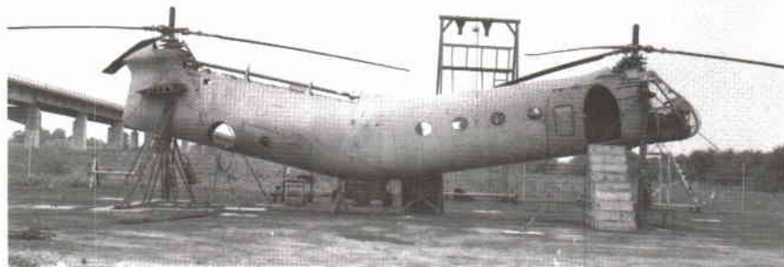
Boeing YH 21 ombyggd till en av världens första provanläggningar för rotorblad i Philadelphia
