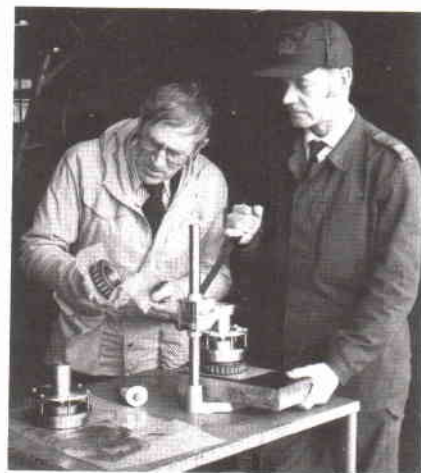
Ove Huzell granskar ett hjullager, som Kurt Engström fyllt med fett i det nya snabbsmörjdonet.
